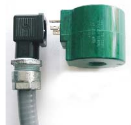
Cewka z przyłączem szybkorozłącznym-wtyczkowym i króćcem \frac{1}{2} " do rurki kablowej (na zdjęciu obok cewki; wtyczka pokazana z kawałkiem rurki kablowej elastycznej)
