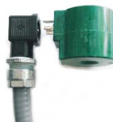
Cewka z przyłączem szybkorozłącznym- wtyczkowym. Wtyczka z króćcem z gwintem wewnętrznym 1/2" do złączki rurki kablowej elastycznej (na zdjęciu obok cewki; wtyczka pokazana z kawałkiem rurki kablowej elastycznej)
