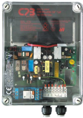
Rys. 13. Zasilacz EBT.1/230. Widok z góry. Zasilacz z przezroczystą pokrywą.
