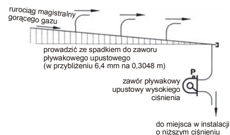
Spust cieczy z rurociągu magistralnego gorącego gazu
