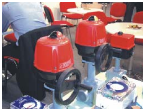
Rys. 13. Zawory kulowe LD z napędami silnikowymi. Napędy z pokrętłami do ręcznego przestawiania zaworu.
