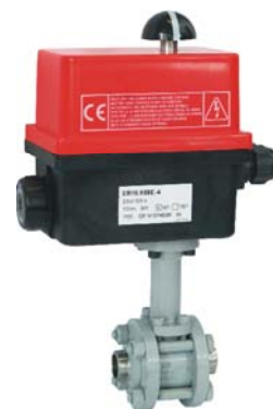
Zawór silnikowy DN 15, pełnoprzelotowy, zamknij/otwórz, 230 V 50 Hz, opcyjnie z wbudowanym zasilaczem awaryjnym
